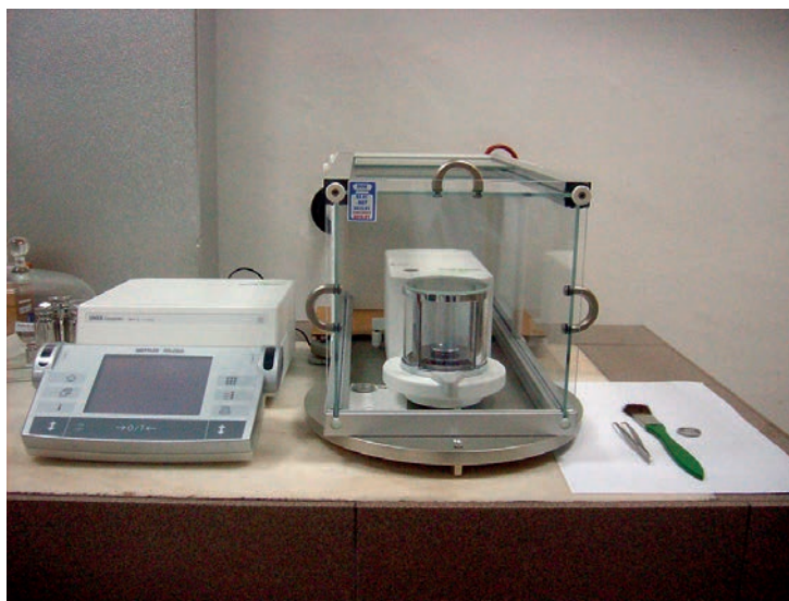
Fig. 1 Comparatorul de masă utilizat în comparații Fig. 1 Mass comparator used in calibration
