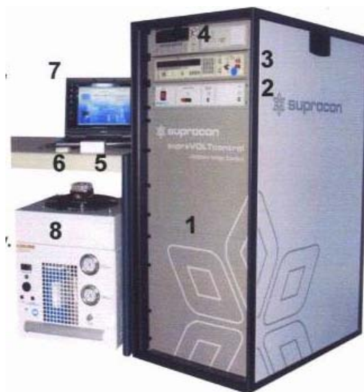
Fig. 3 Instalația cu efect Josephson Fig. 3 The Josephson voltage system
