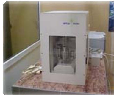
Fig.5: Comparatorul electronic automat de masă de 1 kg și kilogramul prototip național Electronic automatic mass comparator of 1 kg and the national kilogram prototype
