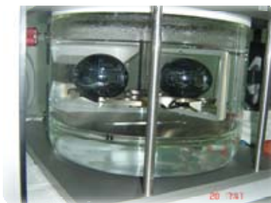
Fig. 6 Comparator electronic de volum cu funcționare automată, pentru determinarea densității corpurilor solide Electronic automatic volume comparator for determining the density of the solids
