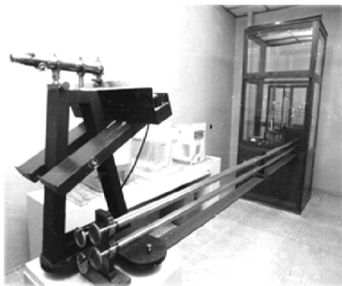
Fig. 1: Balanța cu manevrare și citire de la distanță/ Balance with handling and reading from the distance
