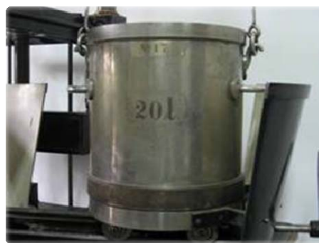
Fig. 8. Etalonul de referință al României pentru masa hectolitrică Reference standard of Romania for Hectolitre mass of cereals
