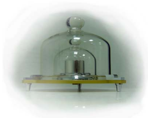
Fig.5: Comparatorul electronic automat de masă de 1 kg și kilogramul prototip național Electronic automatic mass comparator of 1 kg and the national kilogram prototype
