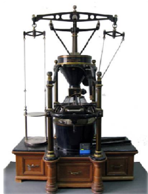
Fig. 8. Etalonul de referință al României pentru masa hectolitrică Reference standard of Romania for Hectolitre mass of cereals
