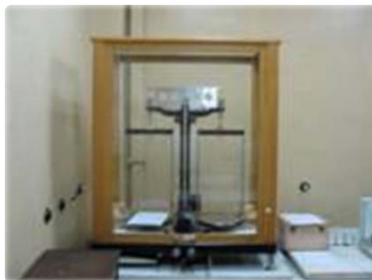
Fig. 4: Balanță etalon secundar ordinul I, fabricație Sauter Standard balance of order I, manufactured by Sauter
