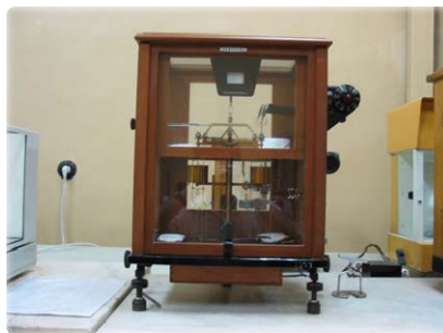
Fig. 3: Balanță etalon secundar ordinul I, fabricație Oertling Standard balance of order I, manufactured by Oertling
