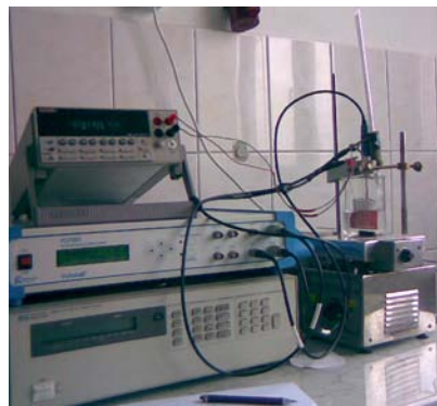
Fig.2 Montajul utilizat pentru electrodepunerea cuprului în CCQM K64 Fig.2 The measurement system used to electro-deposit the copper in the CCQM K64
