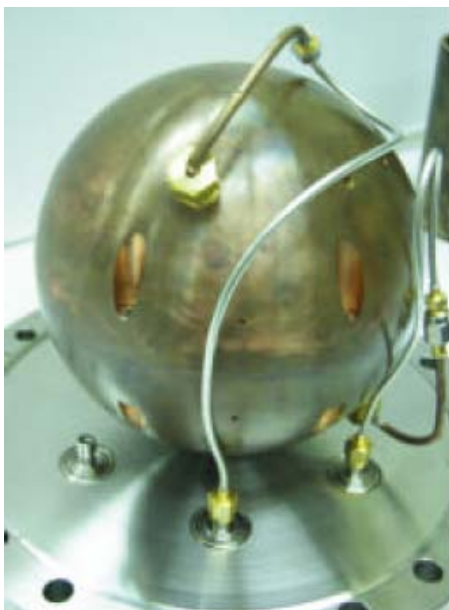
Fig. 2. Rezonatorul acustic sferic utilizat de AGT la NIST (SUA)[10]
